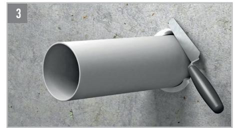
Deckenabschottungen und größere Wandschottungen benötigen eine Schalung. Saugende Flächen der Bauteillaubung mit Wasser benetzen.
